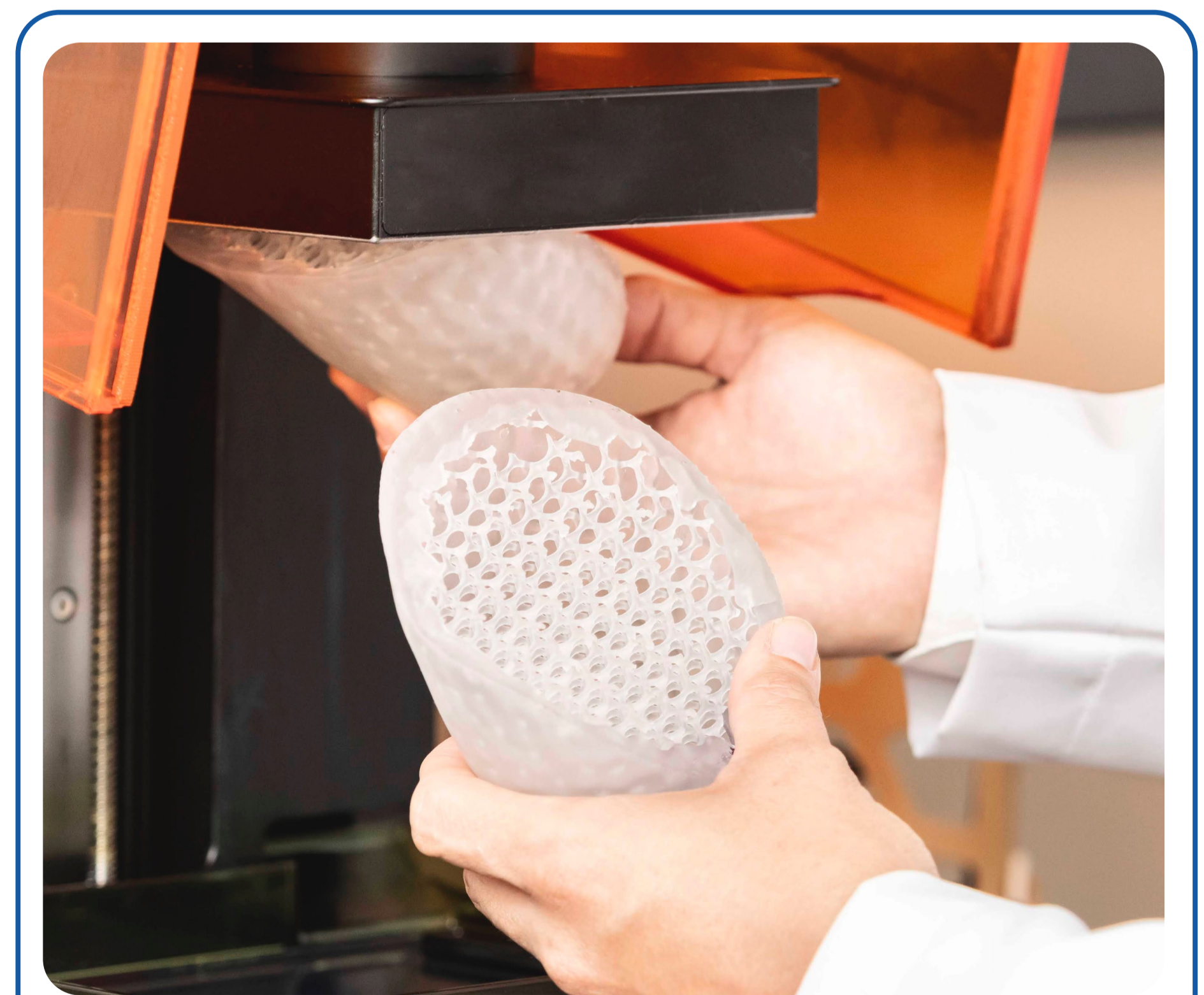
Figura 4: Manufactura aditiva de prototipos de prótesis
