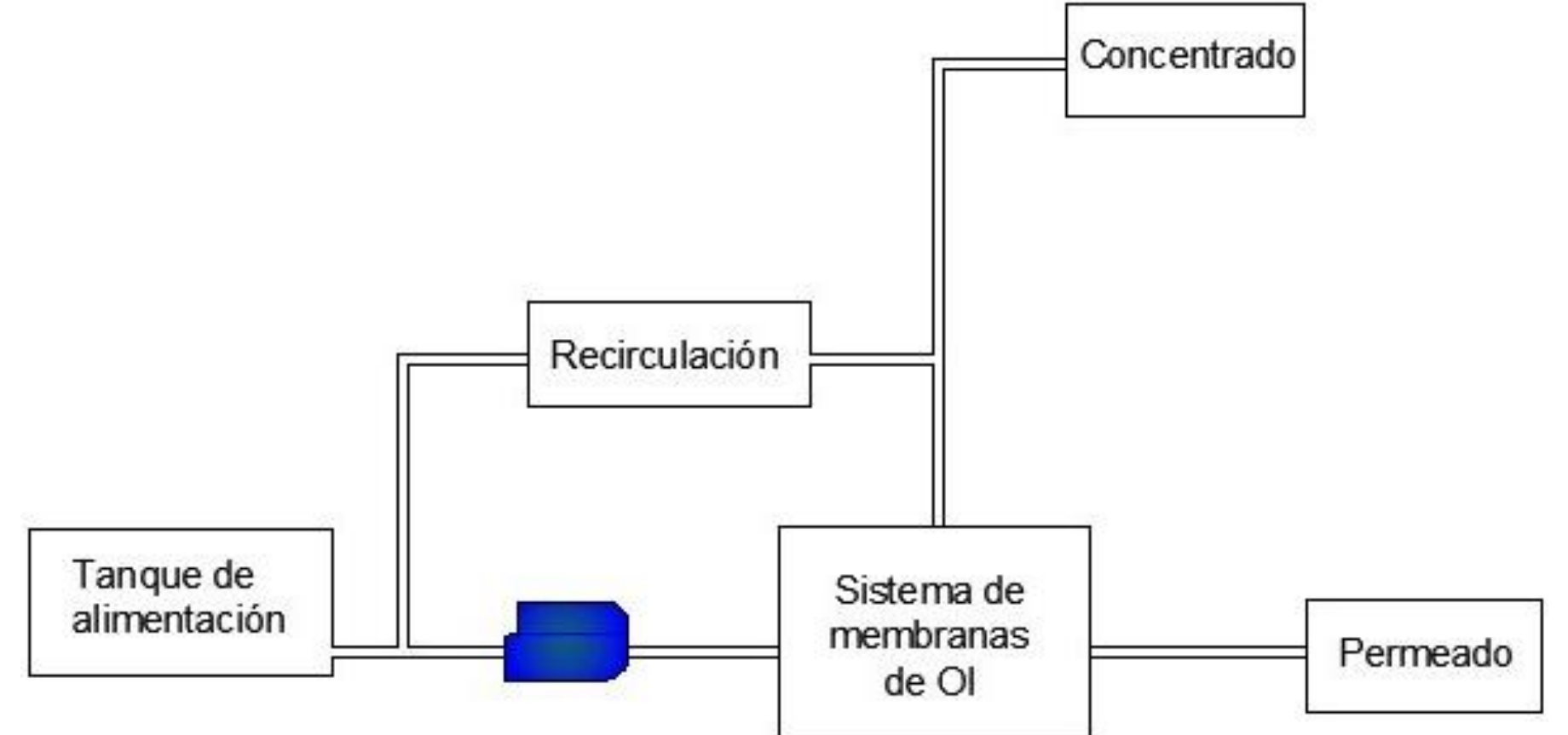
Figura 5. Esquema de planta OI optimizando gastos energéticos
